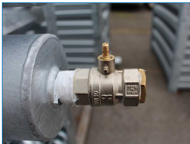
Horné spojenie výmenníka s uvoľňovacím ventilom tlaku na chladiacich vežiach s uzavretým okruhom s pripojením väčším ako ND100.
