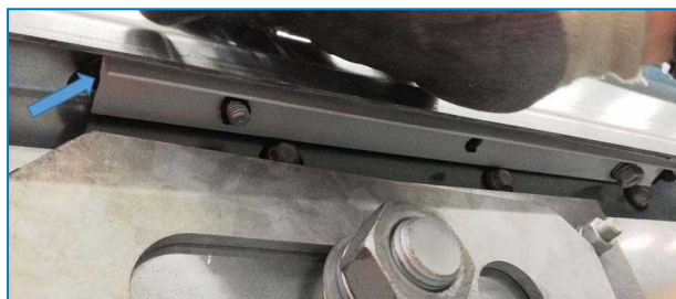
Zamontowany profil uszczelniający
