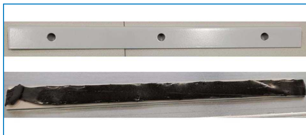
Profil uszczelniający z uszczelniaczem butylowym
