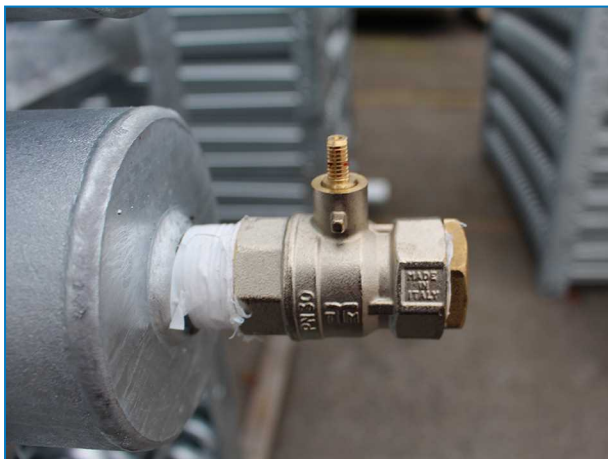
Gornji priključak izmenjivača sa ventilom za otpuštanje pritiska na zatvorenim rashladnim kulama sa priključcima većim od ND100.
