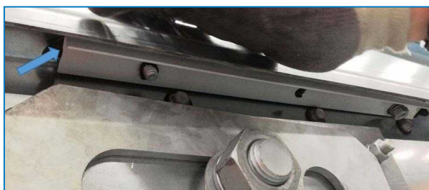
Instaliran profil za zaptivanje
