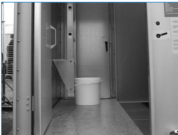
Plaats van kleine hulpstukken en onderdelen voor toestellen met een intern platform
