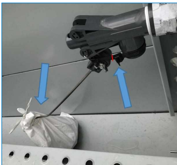
Bevestiging en inwikkeling van de vlotterbal
