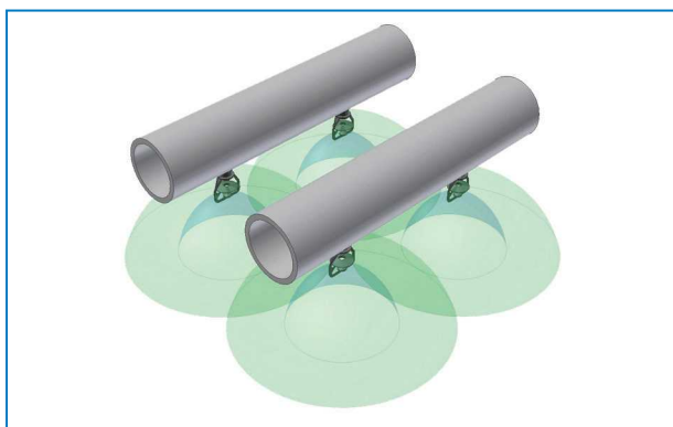
Waterverdeling door sproeikoppen voor loeltoren met gesloten kringloop
