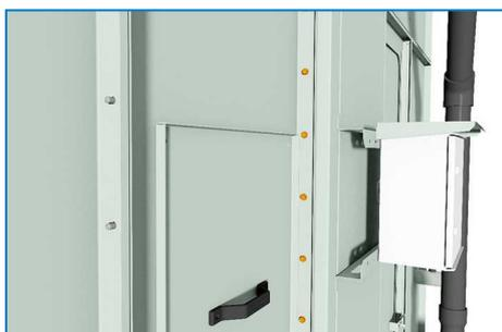
Levante o atenuador de entrada para a posição pretendida. Certifique-se de que os orifícios de fixação do atenuador de entrada ficam alinhados com os orifícios da unidade. Prenda com parafusos.
