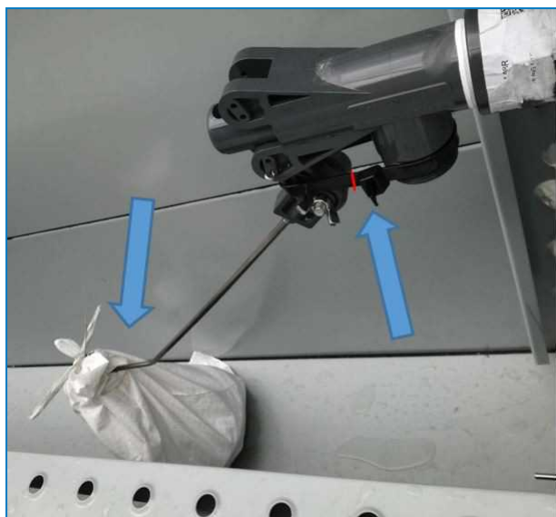
Fissaggio e avvolgimento della palla galleggiante
