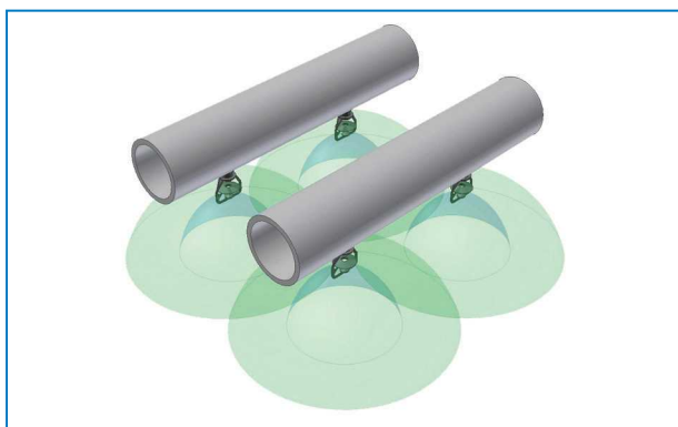
Tipo distribuzione spruzzi dagli ugelli per torre di raffreddamento a circuito chiuso
