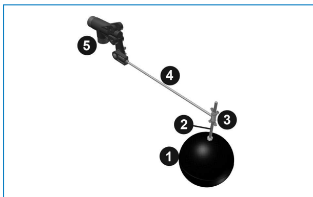
Estrutura da válvula de reposição
