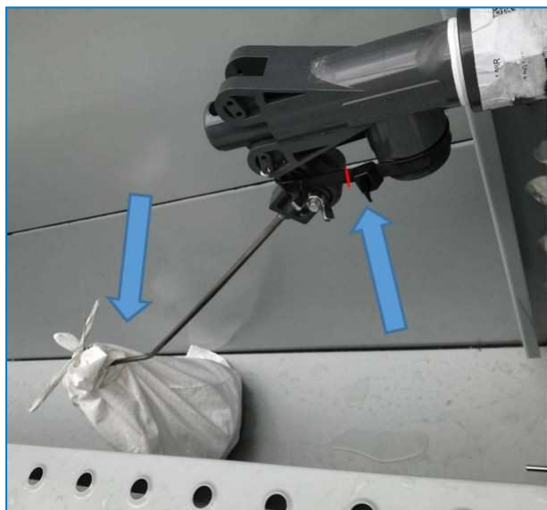
Fixação e envolvimento da boia
