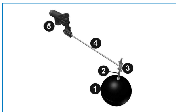
Estrutura da válvula de reposição
