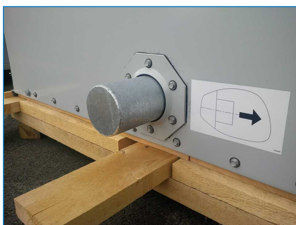
Spodní uzavřené TVT spojení na odpařovacích kondenzátorech.
