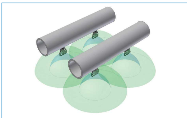
Fúvókás vízelosztású, zárt rendszerű hűtőtorony
