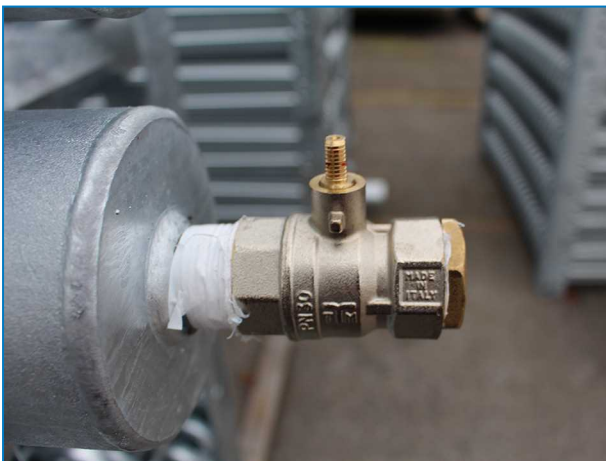
Conexión de batería superior con válvula de liberación de presión en condensadores.
