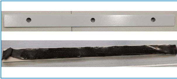
Perfil de sellado con sellador butílico
