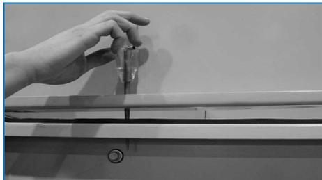
Utilizzo della spina di assemblaggio per allineare i fori di fissaggio
