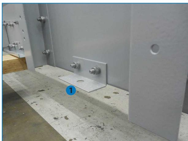
1. Guida/staffa per il montaggio della sezione superiore
