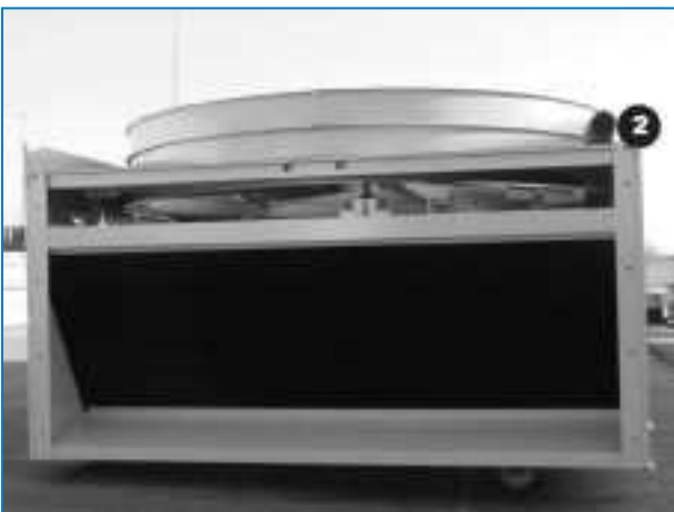
Raccordo tubature pompa sezione plenum esterno
