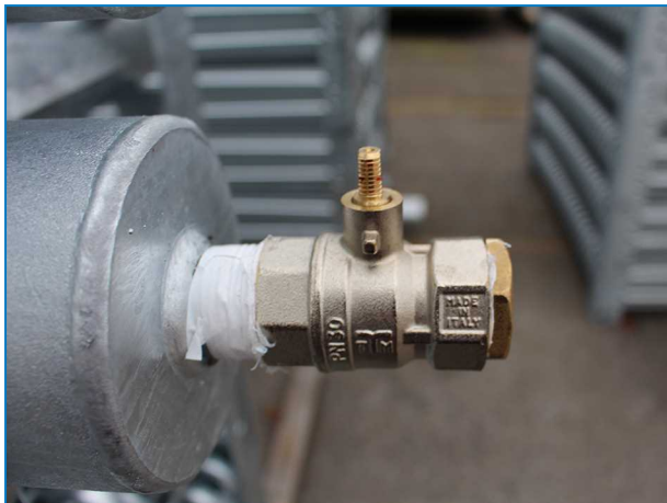
Felső csőköteg-csatlakozás nyomásmentesítő szeleppel kondenzátorok.
