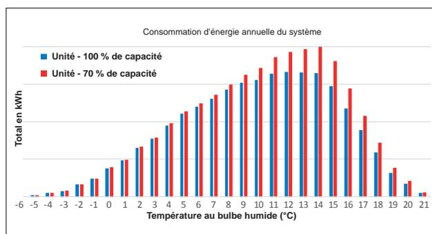
Une unité de ruissellement générique induit 30 % de perte de capacité par an, avec une hausse de 3°C de la température.
