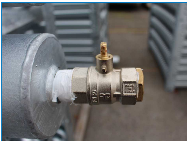
Нерезьбовое соединение теплообменника с клапаном, стравливающим давление, на льдоаккумуляторе для подачи хладагента напрямую.
