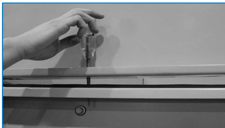
Использование штифта для выравнивания резьбовых отверстий
