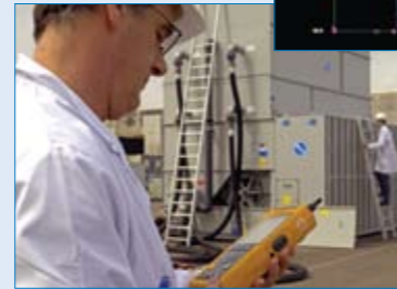
Leistungsversuche an einem Kühlturm
