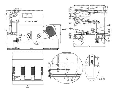
1. Доступ; 2. Подпитка; 3. Электрический поплавковый выключатель; 4. Перелив; 5. Слив; 6. Подсоединение обработки воды; 7. Подача воды в гладкий змеевик НД 100; 8. Выпуск воды из гладкого змеевика НД 100; 9. Воздушный клапан; 10. Подача воды в ТРТВ НД 100; 11. Выпуск воды из ТРТВ НД 100; 12. Трехходовой клапан; 13. Отверстие; 14. Клеммная коробка; 15. Рабочий уровень; 16. Уровень перелива.
