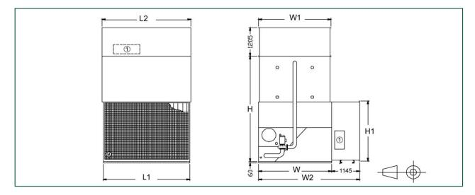
1. Toegangsdeur; L = lengte per toestel; W = breedte per toestel; H = hoogte per toestel (zie technische gegevens).
