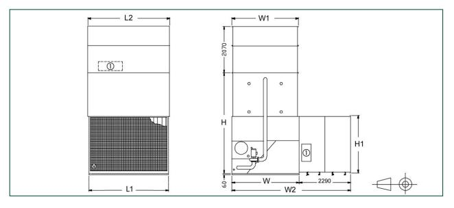
1. Toegangsdeur; L = lengte per toestel; W = breedte per toestel; H = hoogte per toestel (zie technische gegevens).
