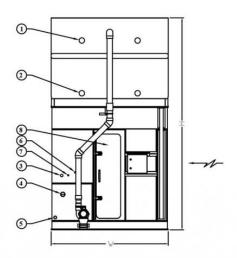
1. Koelmiddel in ND100; 2. Koelmiddel uit ND100; 3. Make-up ND40; 4. Overloop ND80; 5. Afvoer ND50; 6. Spui ND25; 7. Behandeld water in ND20; 8. Toegangsdeur.
