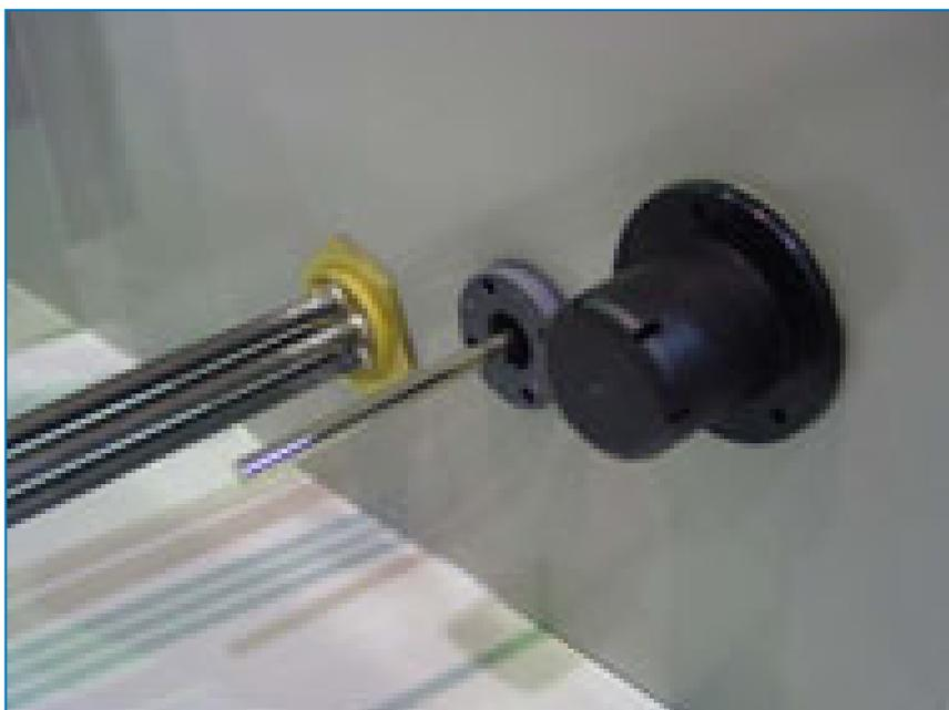
Le nostre resistenze, installate in fabbrica, mantengono la temperatura dell'acqua a 4 °C, agendo come **semplice ed economico dispositivo anti-gelo per la vasca dell'acqua**. Il kit resistenza include le **resistenze elettriche**, un **termostato** e un **interruttore di livello minimo** per proteggere le resistenze qualora il livello dell'acqua si riduca in modo eccessivo. Le resistenze elettriche standard possono gestire temperature ambiente fino a -18 °C.
