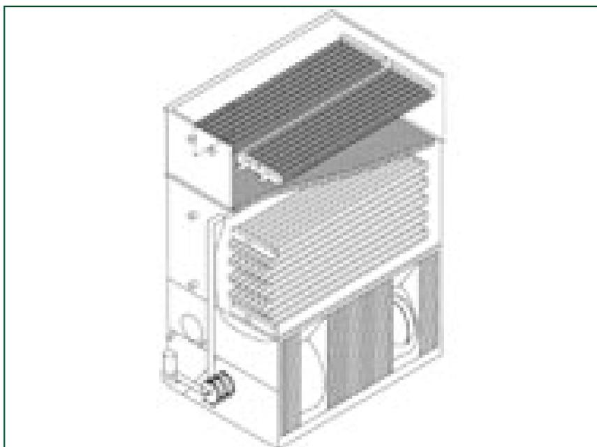
Il gas in uscita proveniente dai compressori alternativi ad ammoniaca (R-717) è altamente surriscaldato e deve essere **raffreddato** tramite la batteria di un desurriscaldatore prima di entrare nella batteria di condensazione.
