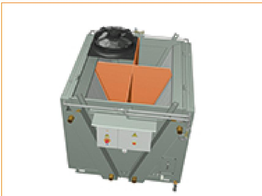
Dotare una unità di pannelli di separazione significa fornire una **singola canalizzazione per l'ingresso dell'aria per ciascun ventilatore** sul raffreddatore adiabatico. Ciò garantisce una capacità maggiore in caso di guasto dei ventilatori in quanto si evitano flussi d'aria indesiderati attraverso un ventilatore non in funzione che bypassa la batteria.
