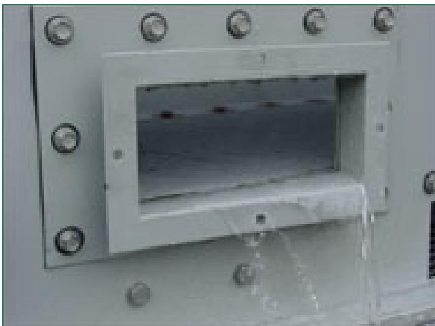
La trappe de nettoyage installée en usine
