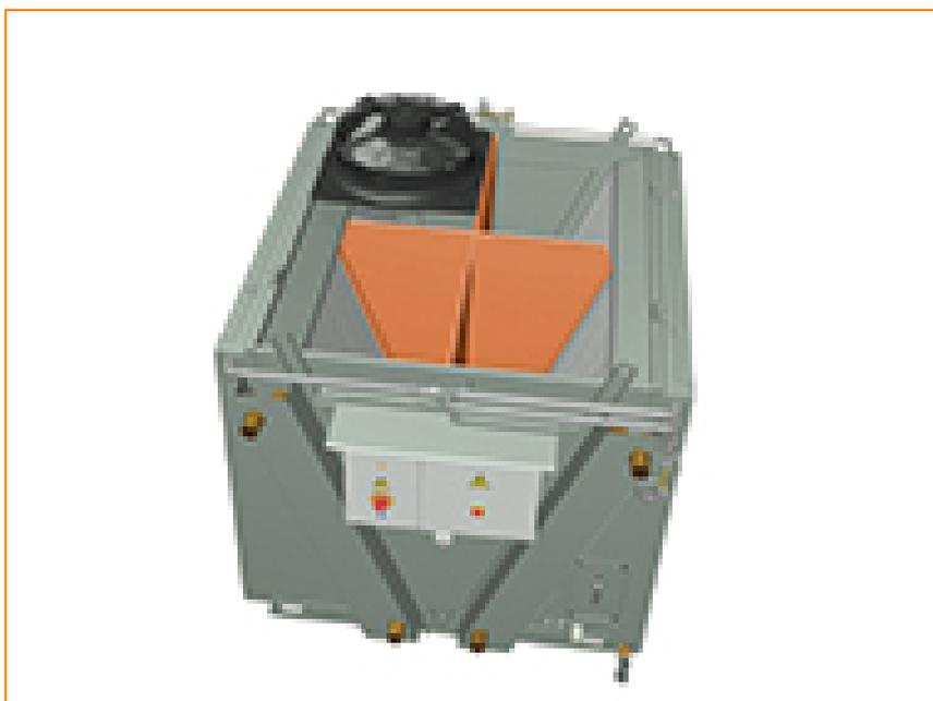
Équiper un appareil de panneaux de séparation assure une **prise d'air pour chaque ventilateur** du refroidisseur adiabatique. Ce qui garantit une plus grande capacité en cas de panne de ventilateur, et ce en évitant que l'air ne contourne la batterie à travers un ventilateur à l'arrêt.
