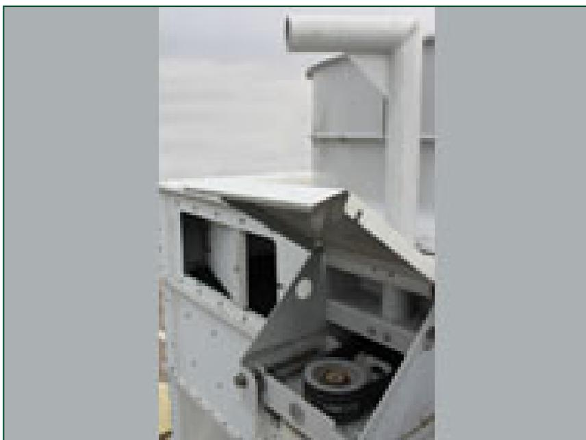
Con el pescante de extracción, **bajar o elevar** el motor de la parte superior de la unidad es muy fácil.
