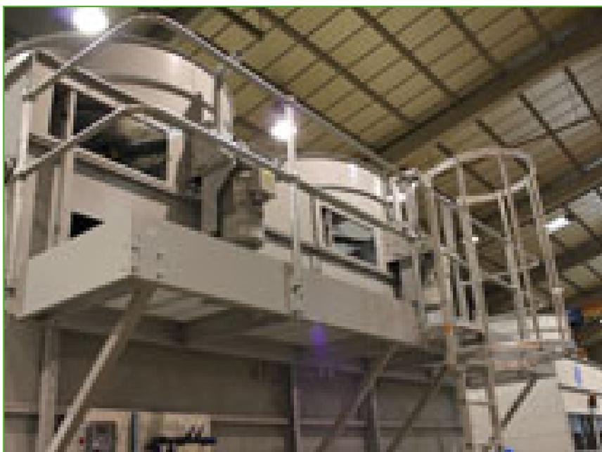
Las plataformas, la escalerilla, la jaula de seguridad y la barandilla permiten un acceso **más sencillo y seguro** a la unidad, lo que facilita la inspección y el mantenimiento, además de la conformidad con las normas europeas de seguridad.
