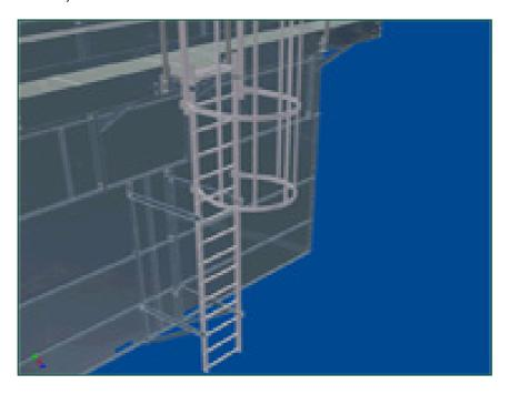
Eine Leiter, ein Sicherheitskorb und Geländer werden für den **problemlosen Zugang zur Oberseite des Geräts und die einfachere sicherere** Inspektion und Wartung in Übereinstimmung mit den **EU-Sicherheitsrichtlinien** installiert.
