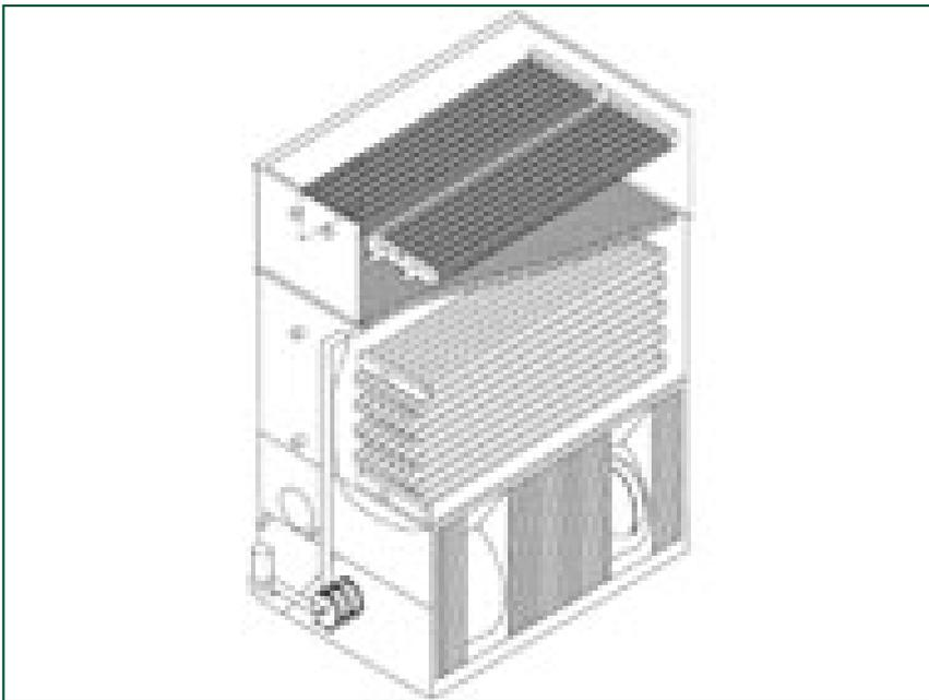
Ammoniakkolbenverdichter (R-717) geben äußerst überhitztes Gas ab, das über das Enthitzerrohrbündel **abgekühlt** werden sollte, bevor es in die Verflüssigerschlange gelangt.
