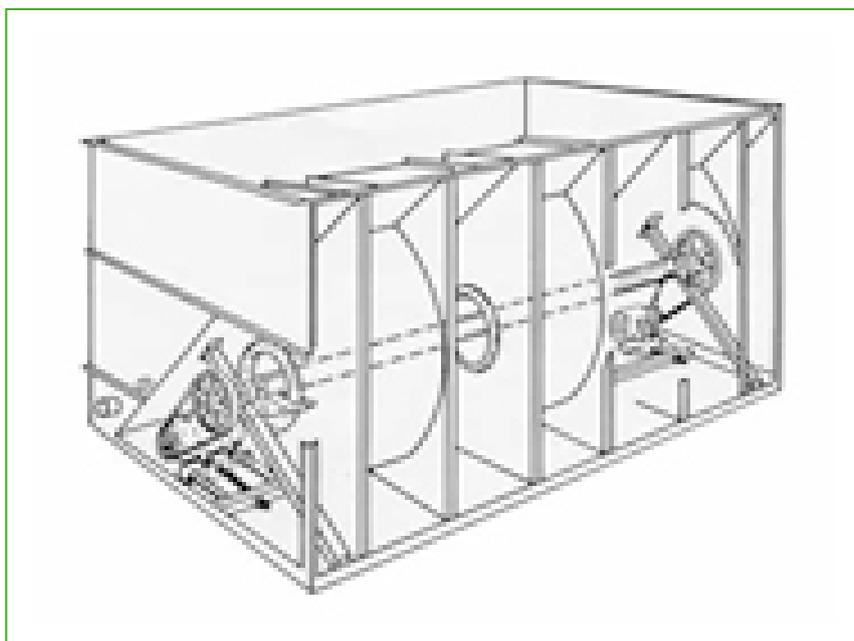
Der Einbau eines Baltiguard<sup>®</sup>-Antriebssystems
