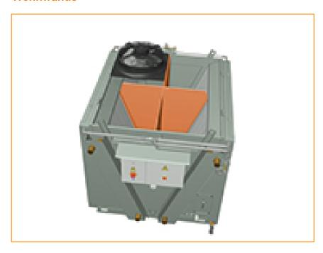
Bei Ausstattung eines Geräts mit Trennwänden wird ein **einzelner Lufteinlasskanal für jeden einzelnen Lüfter** am adiabatischen Kühlgerät bereitgestellt. Dies garantiert eine höhere Leistung bei einem Lüfterausfall, indem unbeabsichtigte Luftströmung durch einen Lüfter im Leerlauf vermieden wird, die das Rohrbündel umgeht.
