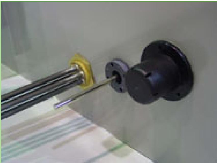
Unsere im Werk eingebauten Heizstäbe halten die Wassertemperatur bei 4° C und fungieren als einfache und wirtschaftliche **Gefrierschutzmaßnahme für das Beckenwasser**. Das Heizungspaket beinhaltet die **Heizstäbe**, einen **Thermostaten** sowie einen **Wassermangelschalter** zum Schutz der Heizstäbe bei zu geringem Wasserstand. Die elektrischen Standardheizstäbe sind für Umgebungstemperaturen bis 18° C geeignet.
