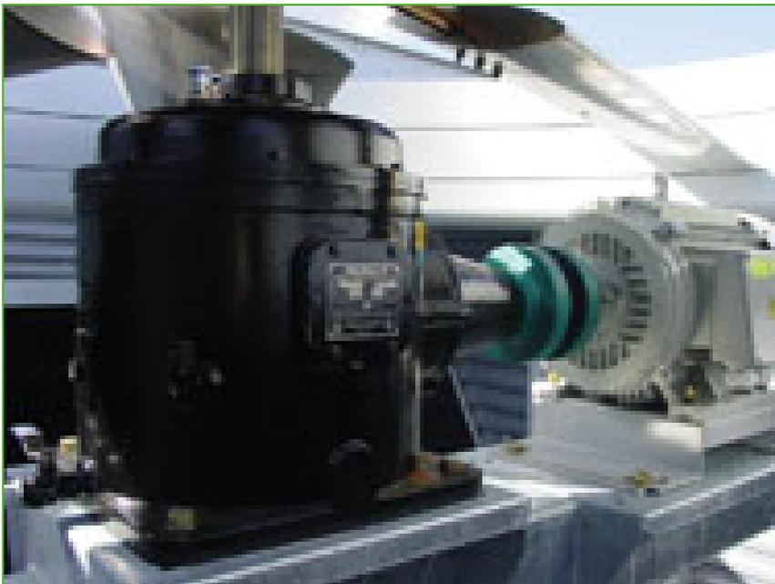
Das im Werk eingebaute und ausgerichtete Antriebssystem mit direktangetriebenem Motor ist eine gute Option für **bestimmte industrielle Anwendungen**.
